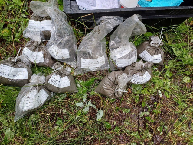
HS1 kaikki 12 0,5m kerrosvälin näytettä. Osa tuplamuovipusseissa koska niin kosteita näytteitä.
