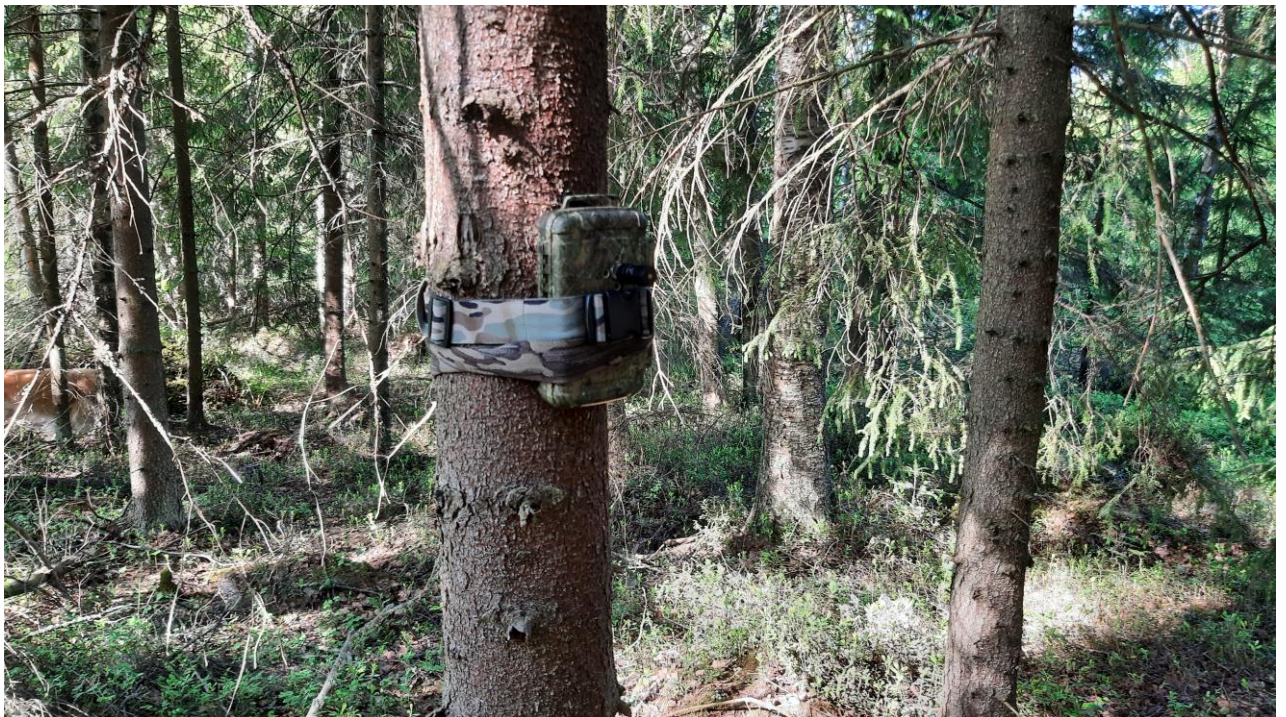
Kuva 5 Lepakoiden seurantaan tarkoitettu passiivitalennin.
