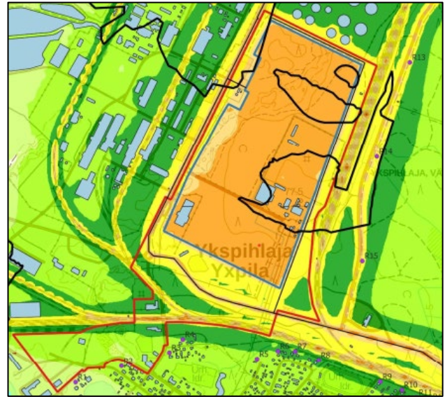
Kuva 51. Kaavamuutoksen mukaisen toiminnan sekä auto- ja raideliikenteen aiheuttama päiväaikainen melu ilman meluvallia.
