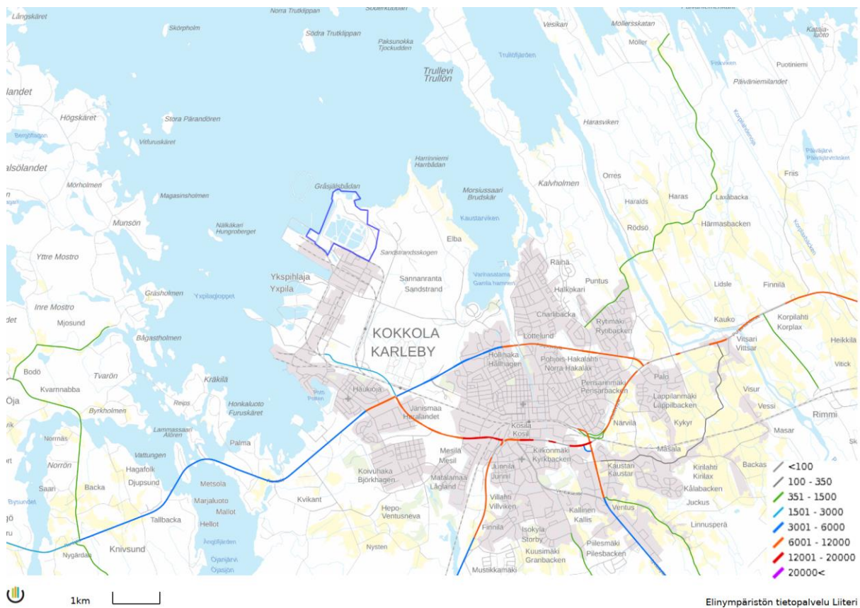
Kuva 4-7. Keskimääräiset vuorokausiliikennemäärät vuonna 2020 (ajoneuvoa/vrk). Kaava-alueen sijainti on osoitettu sinisellä viivoituksella. (Elinympäristön tietopalvelu Liiteri 2023)
